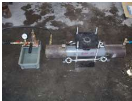
図 9 水圧試験状況
